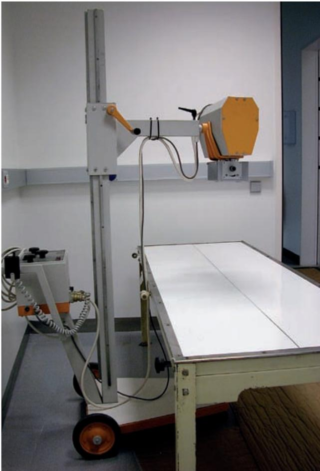
Figura 1. Unidad de rayos X portátil. Radiología modelo TX-70/100, n.º 6774. Tensión red 220-240 v. Potencia 6 Kva. Frecuencia 50-60 Hz. Fotografía: Archivo OAMC.
